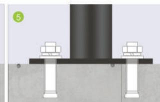
⑤ Serrer les quatre écrous pour terminer l'installation.
